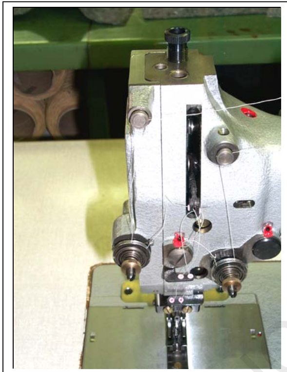
DETAIL:points lubrification sur la CORNELY 10
